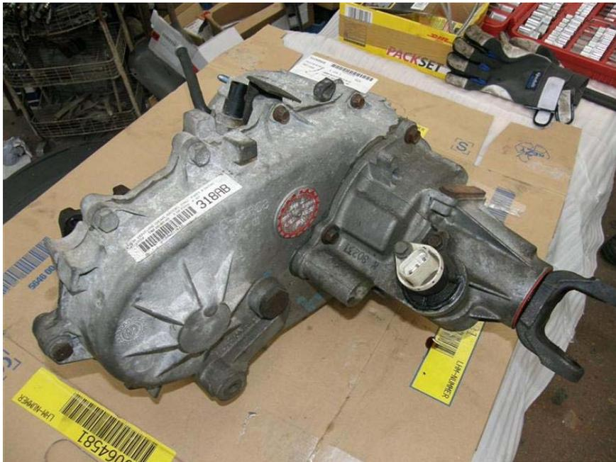
Dann wird die kleine Abdeckplatte entfernt. Unter ihr befindet sich ein Sicherungsring, welcher zum Zerlegen notwendig ist.
