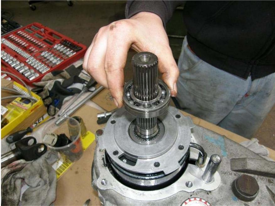
Nun wird die Ölpumpe entfernt. Bitte nicht vergessen gleichzeitig das Ölrrohr mit abzuziehen.
