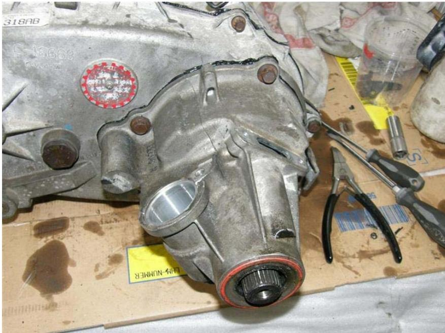
den Antrieb für die vordere Kardanwelle wieder anschrauben,
