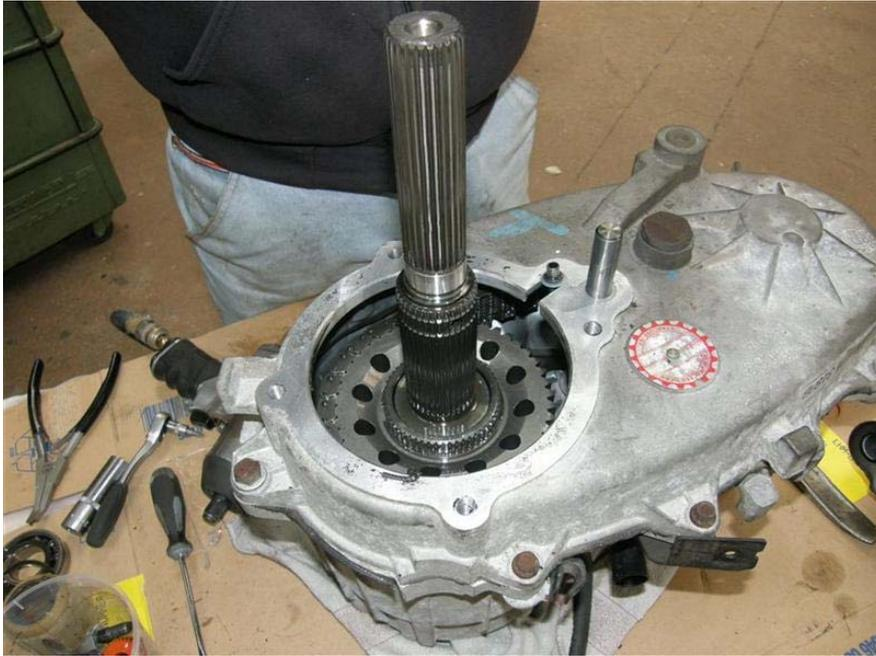
Wer die Kette auch wechseln möchte löst jetzt die Schrauben vom Gehäuse (merkt Euch an welchen Schrauben sich Halterungen befinden und wie diese angeordnet sind)
