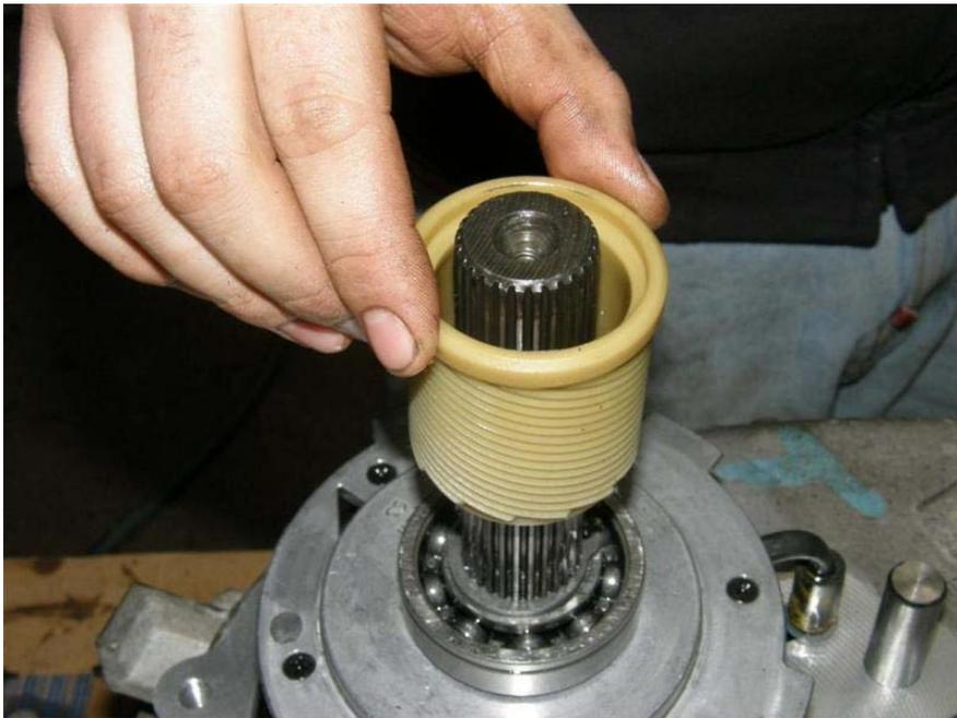
das hintere Gehäuseteil mit Silikon einschmieren,
