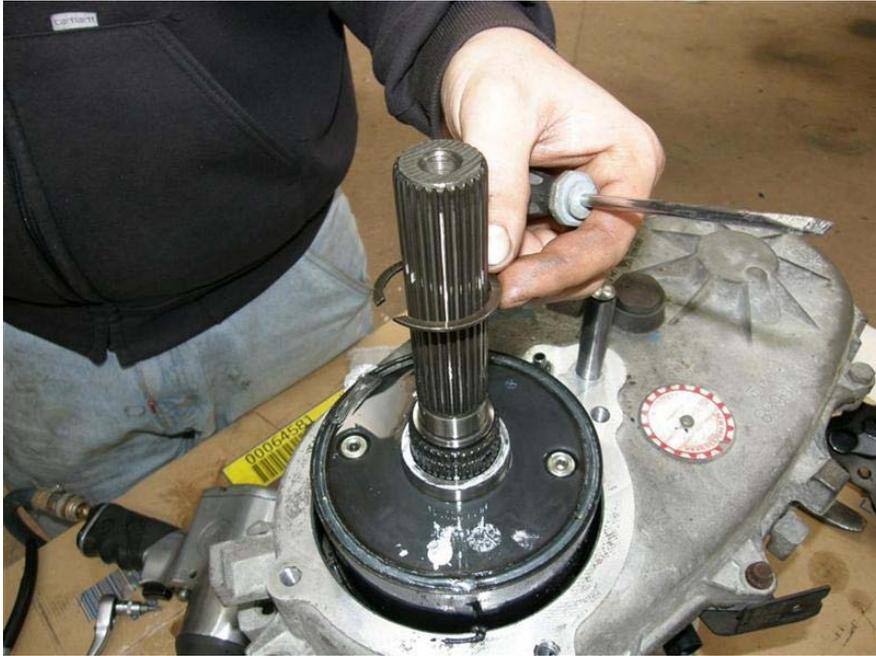
Jetzt kann die Viscokupplung entfernt werden.
