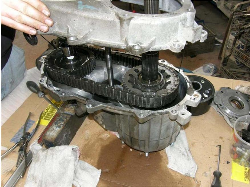
Dann wird die Halterung (Yoke) für die vordere Kardanwelle entfernt.
