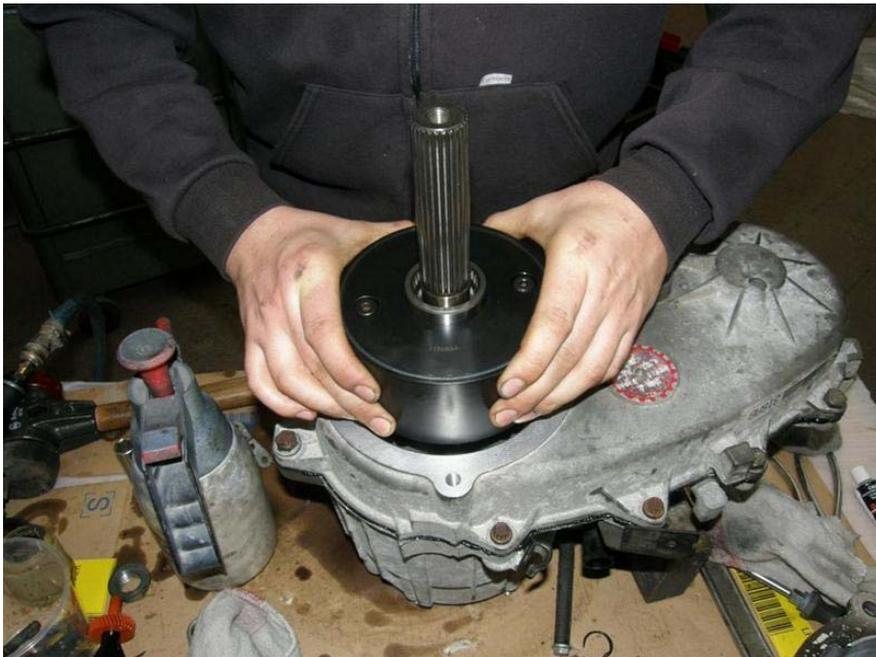
die beiden Sicherungsringe werden wieder aufgesetzt,
