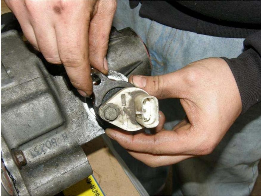
und abschließend die kleine Abdeckplatte von dem Sicherungsring wieder befestigen.
