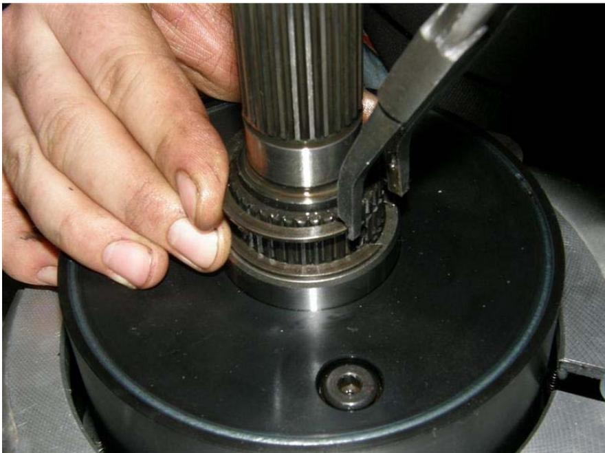
und die Ölpumpe wird wieder aufgesetzt.
