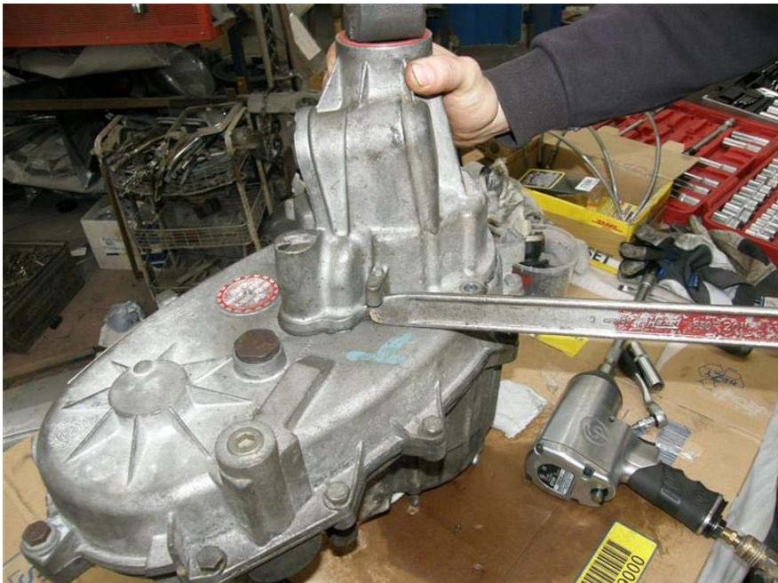
Wenn es gelockert ist, müsst Ihr mit einer Sprengringzange den vorhin beschriebenen Sicherungsring auseinanderdrücken und das Gehäuseteil abheben. Der Ring wird nicht herausgenommen und verbleibt im Gehäuse.
