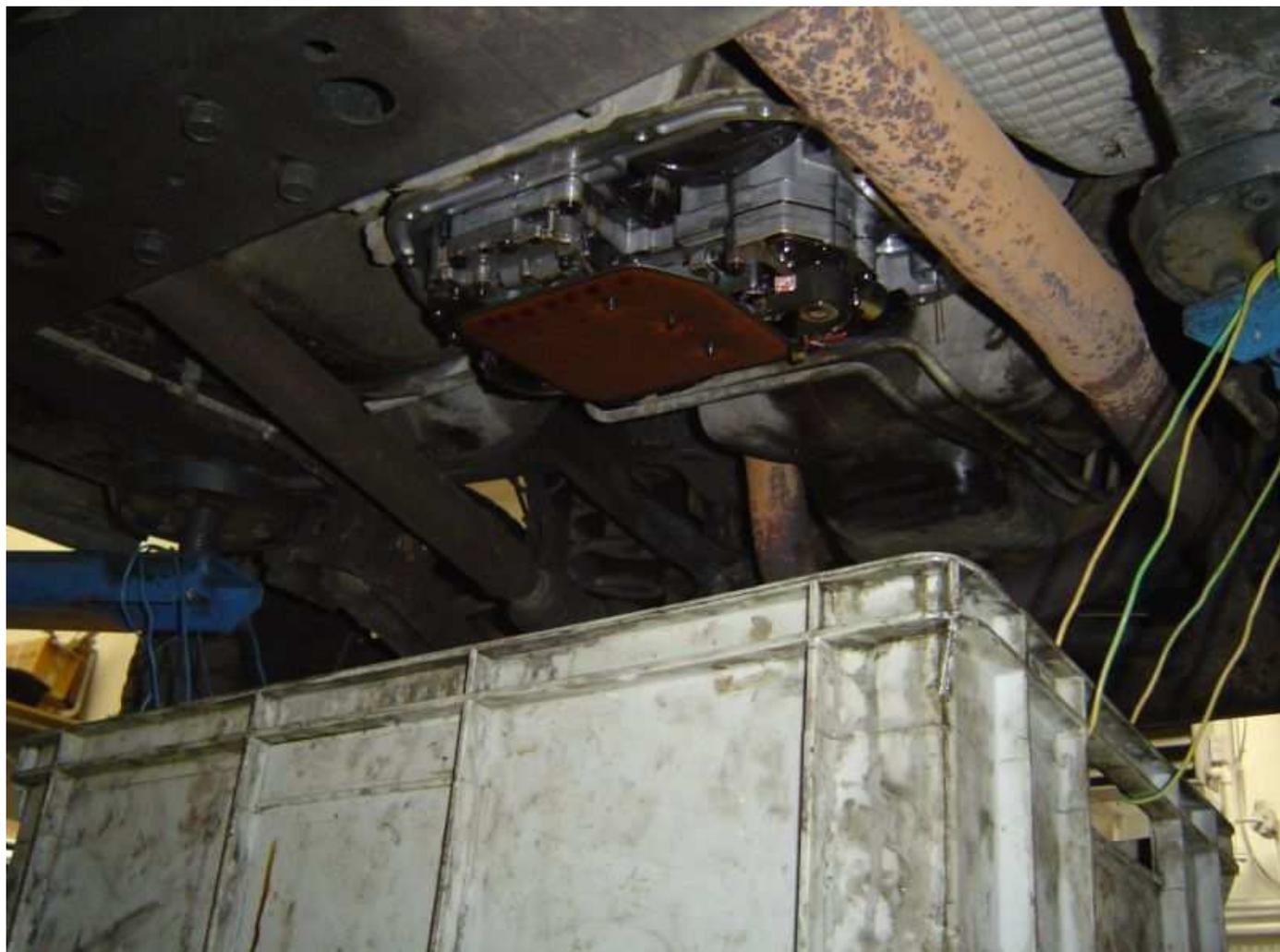
Bevor der neue Filter eingebaut wird, erstmal den Valvebody (Steuerkasten) und was sonst noch so zu sehen ist schön mit Bremsenreiniger sauber machen, ebenfalls die Wanne säubern.
