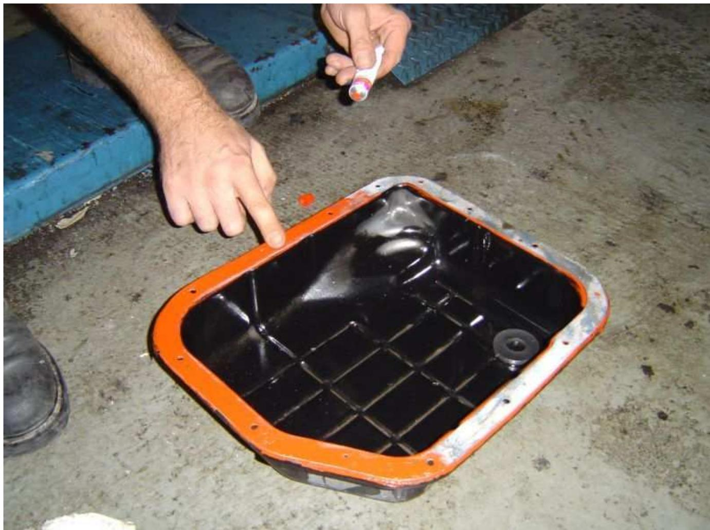
Anschliessend das Ganze entsprechend dem FSM beherzt wieder zuschrauben ( kreuzweises Anziehen der Schrauben mit entsprechendem Drehmoment ) und dieser Teil der Arbeit war geschafft. Angaben zu den Drehmomenten am Ende dieser Anleitung.
