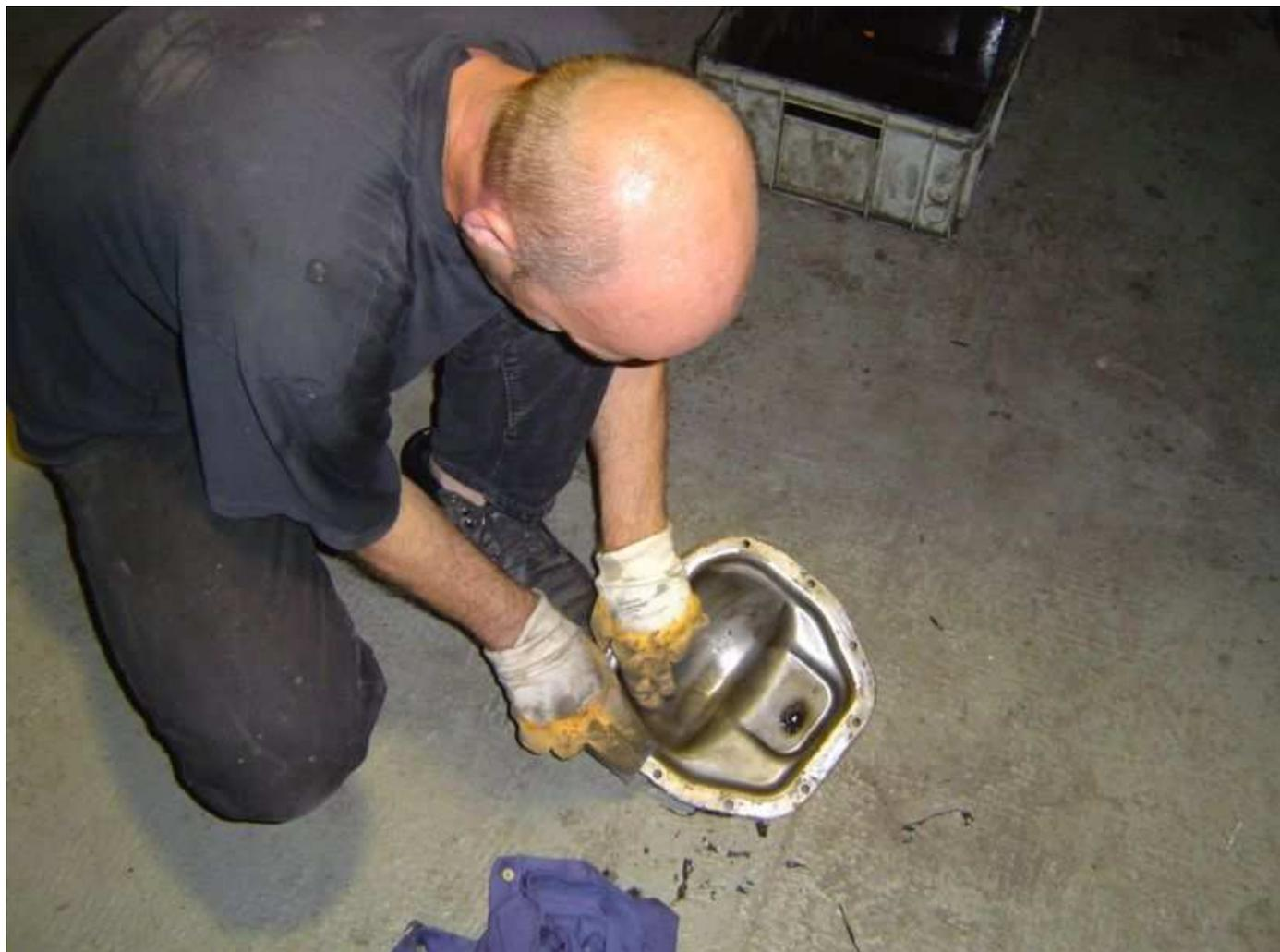
Wenn alles sauber ist, Dichtungsmasse auf den Deckel gleichmäßig verteilen:
