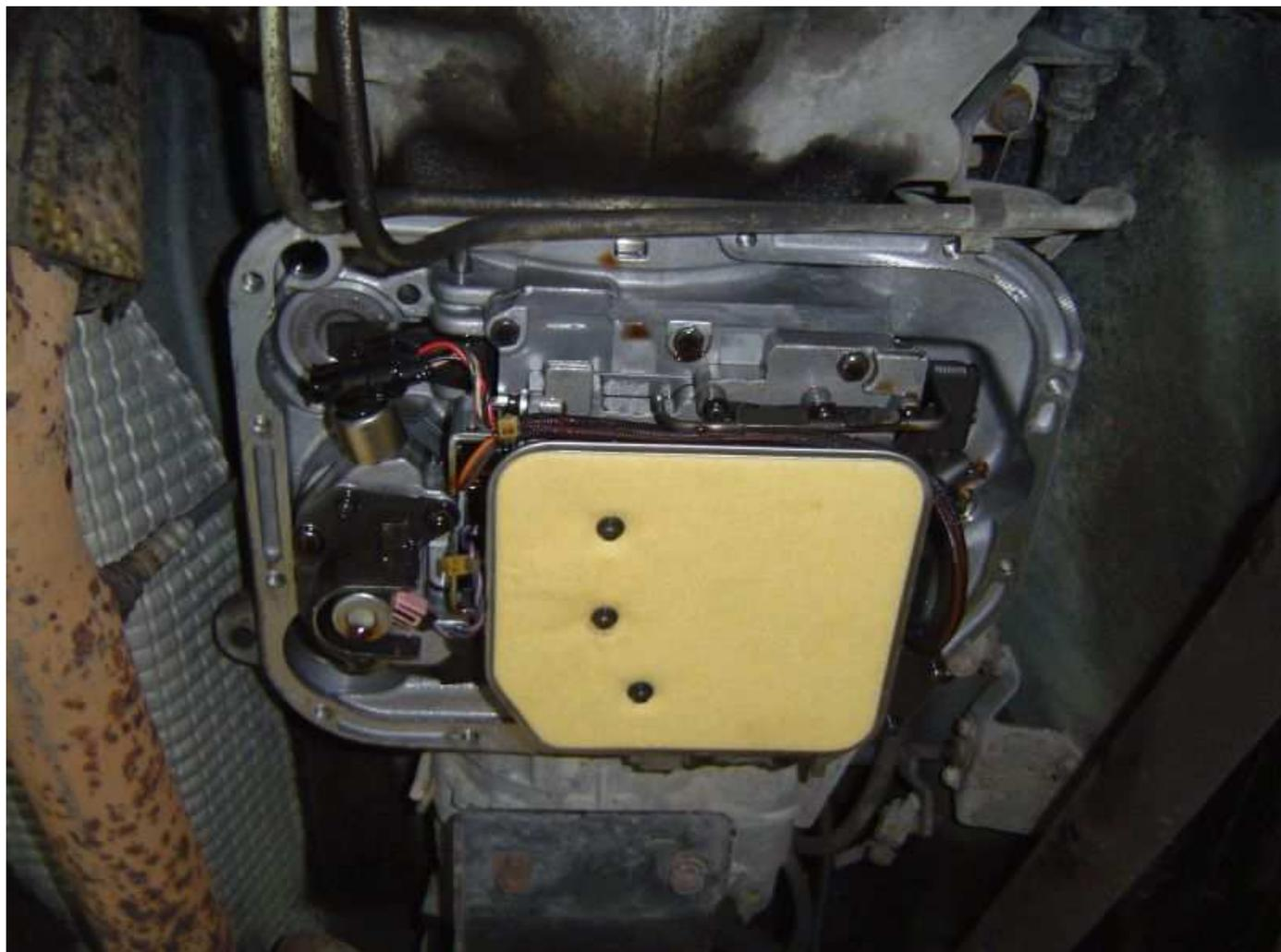
Neue Dichtung auf dem Deckel des ATG mit Dirko fixiert, damit sie beim Einbauen bloss nicht verrutscht und hinterher alles undicht ist.
